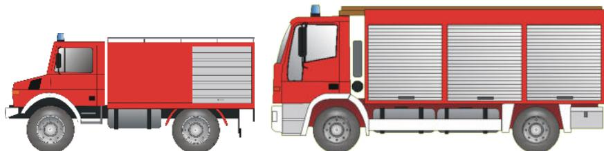
Feuerwehrfahrzeug mit großem Wasservorrat und Beladung für die Brandbekämpfung. Tanklöschfahrzeuge werden nach Norm über die Leistung der Feuerlöschkreiselpumpe und die Größe des Wasservorrats benannt:
