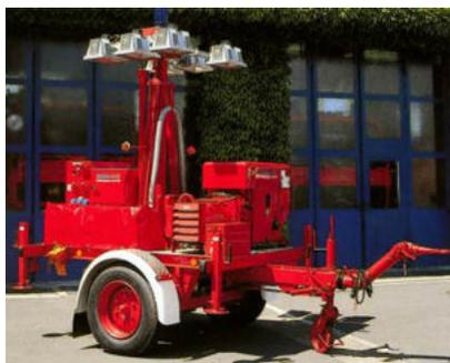
Anhänger mit einem Lichtmast zur Ausleuchtung von Einsatzstellen. Je nach Leistungsfähigkeit des Generators kann auch elektrische Energie für zusätzliche Verbraucher bereitgestellt werden.
