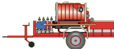
Auf dem Anhänger ist ein Behälter mit Löschpulver inkl. Druckmittel und Angriffsschläuchen zur Bereitstellung von Löschpulver montiert.
