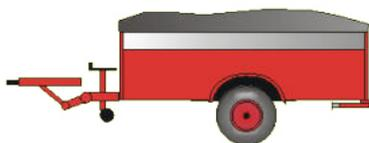
Feuerwehranhänger sind für den Feuerwehreinsatz gestaltete Anhänger mit spezieller Beladung z.B. Rettungsboot oder Löschpulver.
