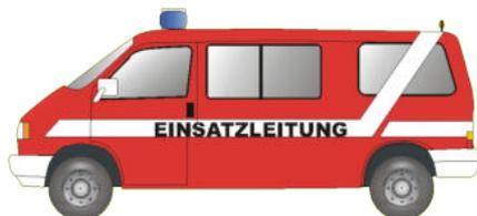
Fahrzeuge der Einsatzleitung, die insbesondere mit Informations- und Kommunikationsmitteln (Alarm- und Einsatzpläne, Gefahrstoff-Nachschlagewerke, Telefon, erweiterbare Funkausrüstung, ggf. Fax, PC mit Datenbanken) ausgerüstet sind. Typen der ELW werden nach Norm in Abhängigkeit von der Größe gekennzeichnet mit ELW 1 (Kleinbus, Transporter) bzw. ELW 2 (LKW oder Abrollbehälter).
