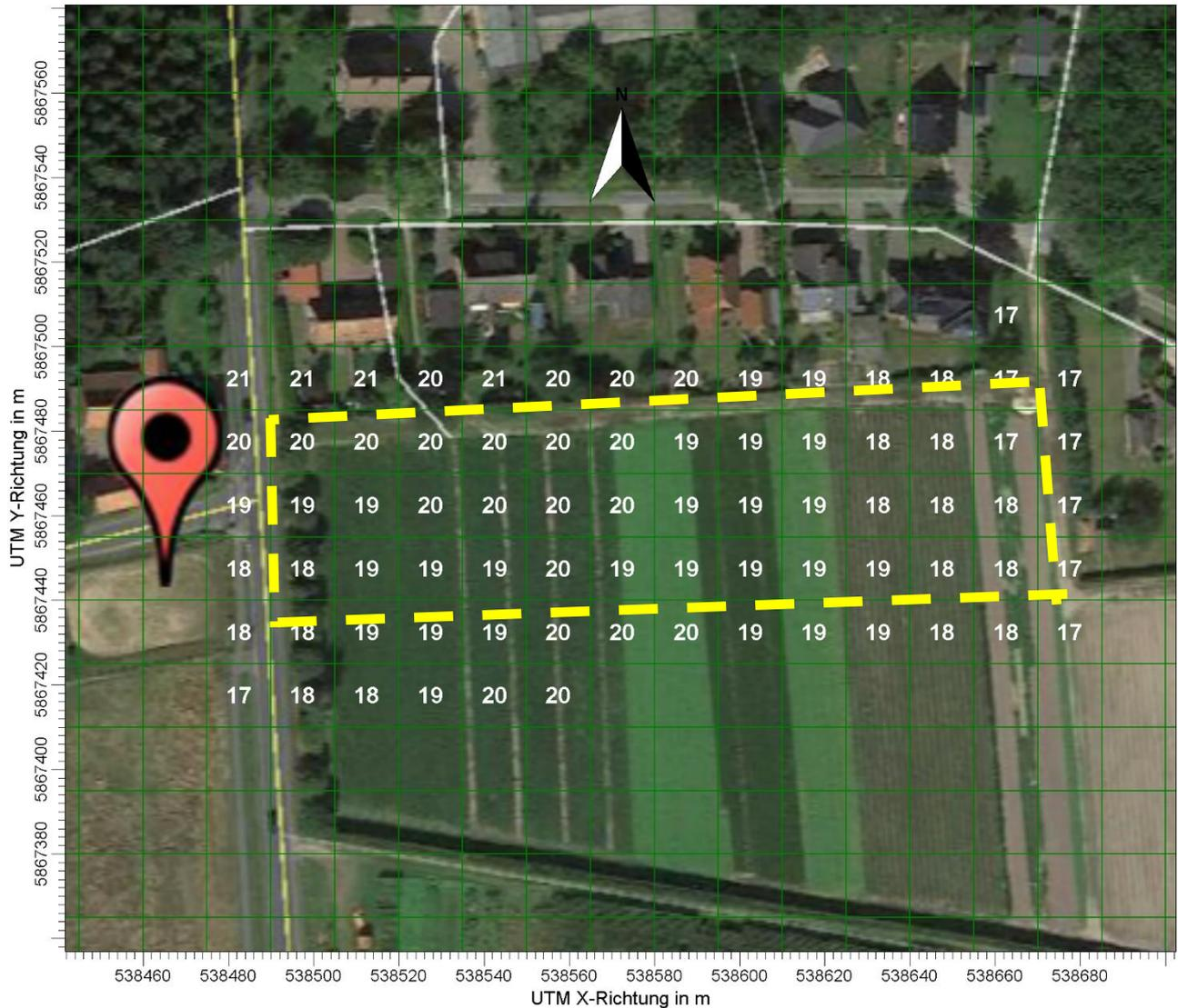
Abbildung 5: Plangebiet B, alle Quellen, Geruchs-Gesamtbelastung in Prozent der Jahresstunden.
